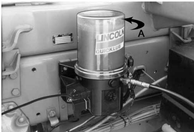
Abb. 9-1 Behälter der Pumpe befüllen
