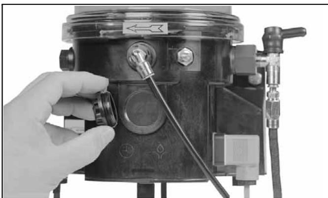
PCB 7 Verschlussdeckel zur Steuerplatine 00002617a
